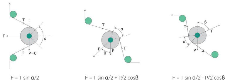
\*T-张力  $\alpha$ -包络夹角 ( $30^\circ \leq \alpha \leq 180^\circ$ ) F-传感器检测受力 P-辊轮自重  $\beta$ -传感器检测受力和辊轮自重方向的夹角
